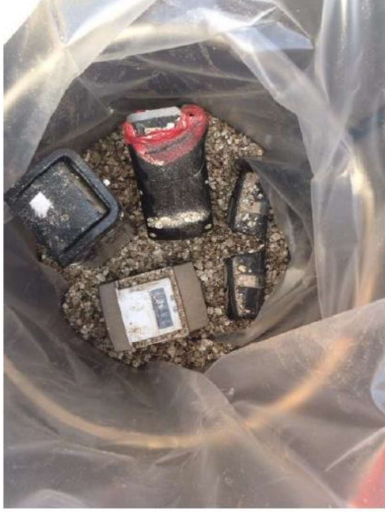
Intaktná batéria so zalepenými kontaktmi
