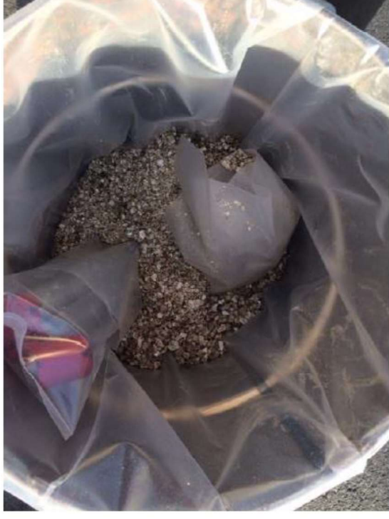
Poškodená batéria v plastovom vrecúšku vo vermikulite
